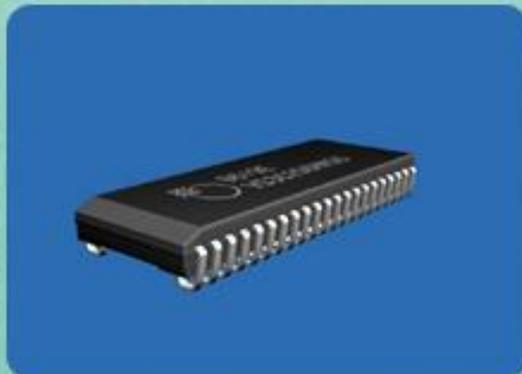
钩形 SOL 封装集成电路，引脚向封装体底部两侧勾回。
