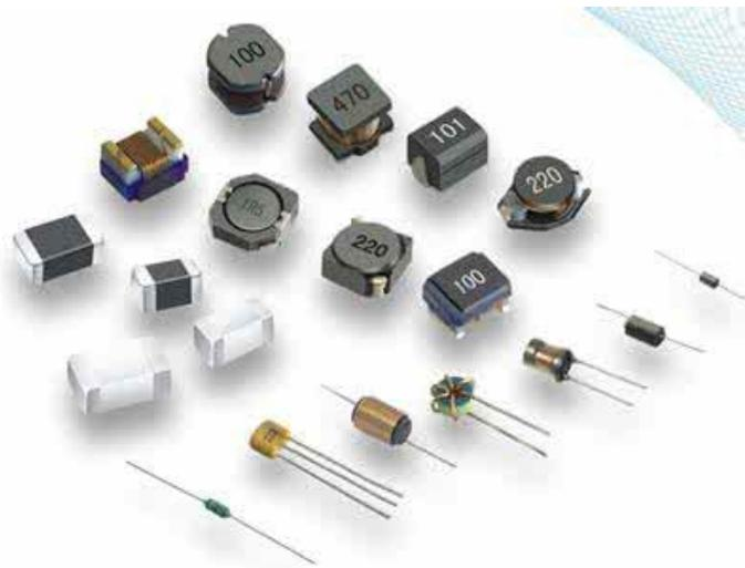
电感器参数表示：电感器电感量的大小，主要取决于线圈的圈数（匝数）、绕制方式、有无磁心及磁心的材料等等。通常，线圈圈数越多、绕制的线圈越密集，电感量就越大。有磁心的线圈比无磁心的线圈电感量大；磁心导磁率越大的线圈，电感量也越大。电感量的基本单位是亨利（简称亨），用字母“H”表示。常用的单位还有毫亨（mH）和微亨（ $\mu\text{H}$ ），它们之间的关系是：
